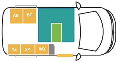
Colonnes AB et BC approfondies pour y loger un réfrigérateur au dessus du passage de roue, et des toilettes portables en dessous.
